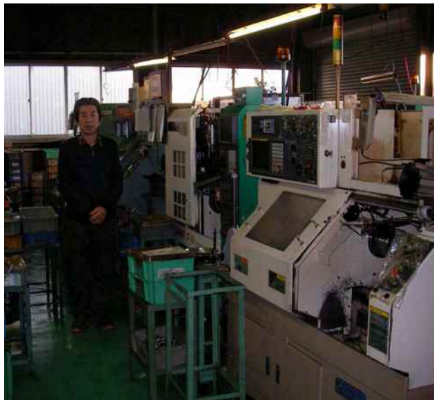
森製作所の主要設備である NC 旋盤
